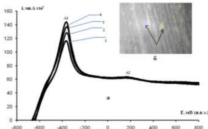
Рис. 6. а) АПК железа Армко в 0,2 М  $\text{H}_3\text{BO}_3$  + 0,05 М  $\text{Na}_2\text{B}_4\text{O}_7$  + X М Gly (1 – X =  $3,0 \cdot 10^{-2}$ ; 2 – X =  $3,4 \cdot 10^{-2}$ ; 3 – X =  $3,6 \cdot 10^{-2}$ ; 4 – X =  $3,8 \cdot 10^{-2}$ ) ( $V_p = 3$  мВ/с) и б) вид локальных поражений после АПК в растворе (1) ( $\times 500$ ). Стрелками указаны ПТ
