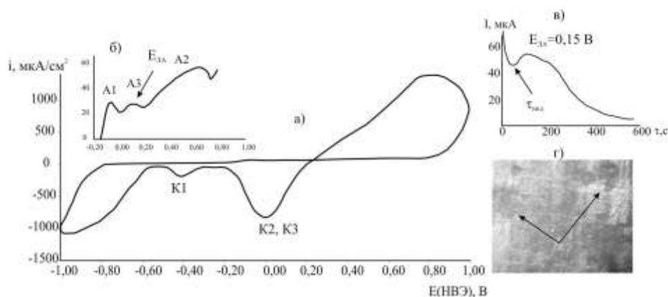
**Рис. 1.** (а) ЦВА меди в растворе  $1 \cdot 10^{-2}$  М NaOH +  $1 \cdot 10^{-2}$  М NaCl и (б) ее анодный участок ( $A_1/K_1$ -Cu/Cu<sub>2</sub>O,  $A_2/K_1, K_2$ -Cu<sub>2</sub>O/CuO, Cu(OH)<sub>2</sub>,  $A_3/K_3$ -Cu/CuCl); (в) ХАГ при  $E_{ЛA}$ , (г) микрофотография локальных поражений меди (показаны стрелками) ((МИМ-7)  $\times 500$ )
