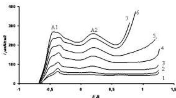
Рис. 3. Анодные участки ЦВА железа Армко в 0,2 М  $\text{H}_3\text{BO}_3$  + 0,05 М  $\text{Na}_2\text{B}_4\text{O}_7$  +  $1 \cdot 10^{-3}$  М  $\text{NaCl}$  (рН = 8,4), снятых с различной скоростью развертки потенциала: 1 – 2; 2 – 3; 3 – 10; 4 – 20; 5 – 30; 6 – 40; 7 – 50 мВ/с
